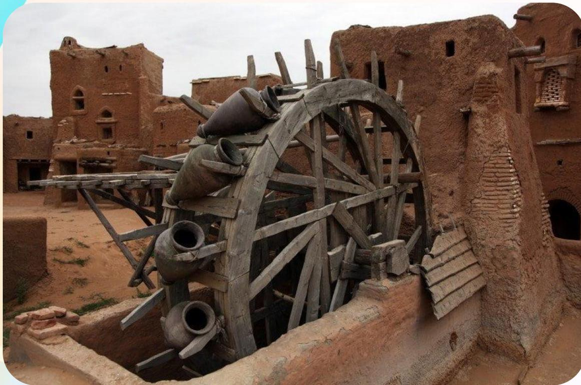
**Известным водоподъемным механизмом древности стало водоподъемное колесо величиной около 3,5 м. Максимальная подача им жидкости составляла 8–10 кубометров в час. Конструкции же, которые можно назвать цепными насосами (это цепи с прикрепленными ковшами) применялись примерно 1700 лет до н. э.**
